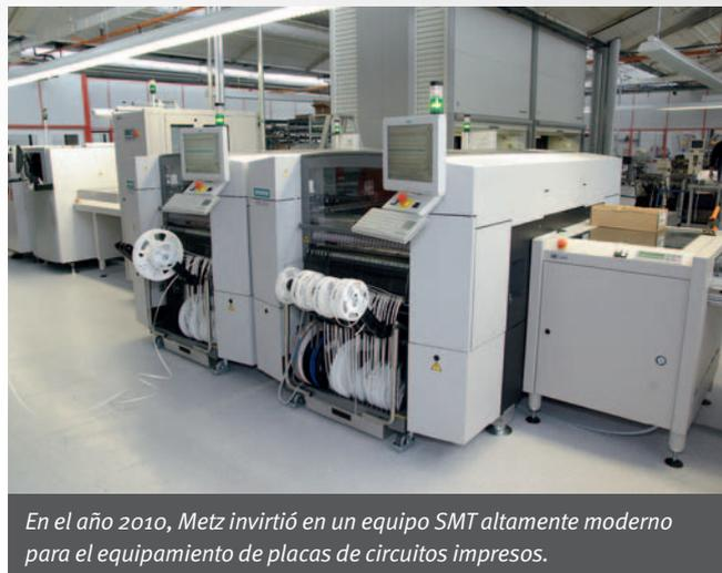
*En el año 2010, Metz invirtió en un equipo SMT altamente moderno para el equipamiento de placas de circuitos impresos.*
