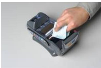
Dos toallitas humeda / seca para la limpieza sencilla y segura de los termo-presores. Utilizando regularmente - aprox. después de 5 rollos de papel – se evitan los depósitos de los restos de papel quemado.
